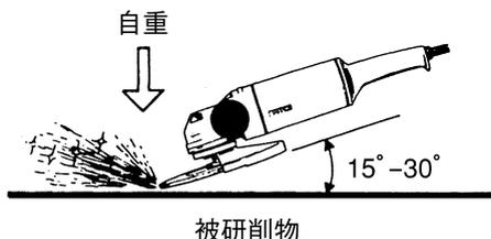
効率の良い研削作業をするには、砥石の全面を使用するのではなく、15°～30°傾け、外周部分で行います。火花が一番多く出る状態が最適です。
