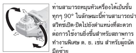
ท่านสามารถหมุนทั่วเครื่องได้เป็นชั้นๆ ทุกๆ 90° ในลักษณะนี้ท่านสามารถนำลูกทิชช์บีดบีดไปยังตำแหน่งที่สุดด้วยตัวเอง ต่อการใช้งานยิ่งชั้นสำหรับสภาพการทำงานพิเศษ ด. ย. เช่น สำหรับผู้คนดัดปีชัย
